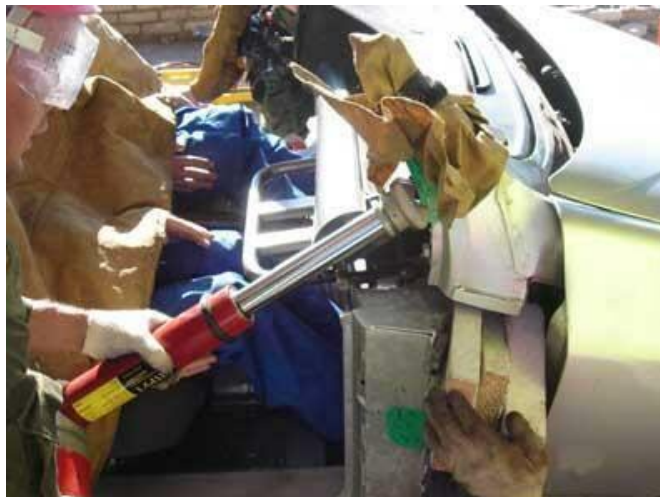
Рис. 6. Установка защиты на острые края и кромки
