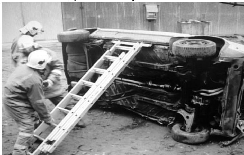
Рис. 4. Стабилизация ТС, лежащего на боку в результате ДТП
