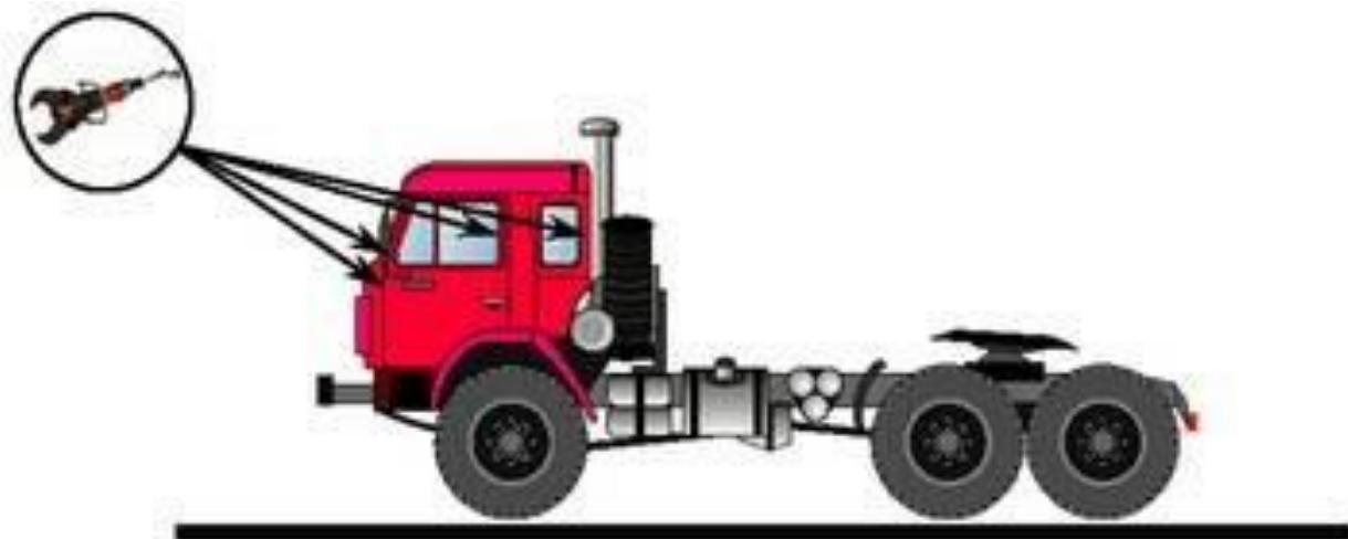
Рис. 12. Схема полного и частичного перекусывания стоек кабины грузового автомобиля при отгибе крыши назад
