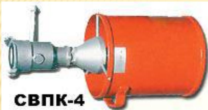
Ручной комбинированный воздушно-пенный ствол типа "СВПК-4" предназначен для формирования и направления струй воздушно-механической пены низкой и средней кратности при тушении пожаров, а также для перекрытия потока.
