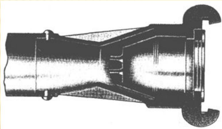
В зависимости от способа подачи водного раствора пенообразователя стволы делают с эжектирующим устройством и без него.
