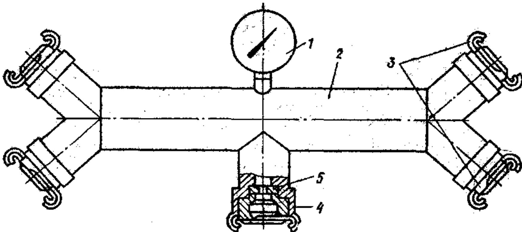
ПРИ ПОДАЧЕ ПЕНООБРАЗОВАТЕЛЯ В ДОЗИРУЮЩУЮ ВСТАВКУ НАСОС, ПОДАЮЩИЙ ПЕНООБРАЗОВАТЕЛЬ, ДОЛЖЕН СОЗДАВАТЬ НАПОР ОТ 2 ДО 30 М (В ЗАВИСИМОСТИ ОТ ЧИСЛА ПОДКЛЮЧЕННЫХ ПЕНОГЕНЕРАТОРОВ) И ВСЕГДА ДОЛЖЕН БЫТЬ ВЫШЕ НАПОРА В РУКАВНОЙ ЛИНИИ.
