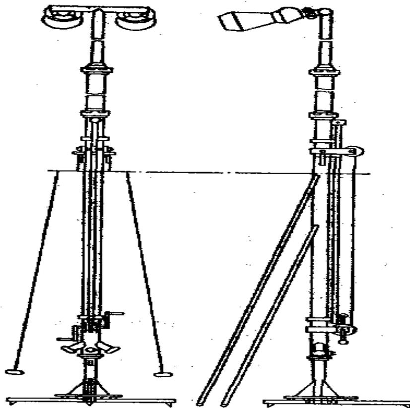
**ХИМИЧЕСКУЮ ПЕНУ ПОЛУЧАЮТ В ПРИБОРАХ, НАЗЫВАЕМЫХ ПЕНОГЕНЕРАТОРАМИ.**
