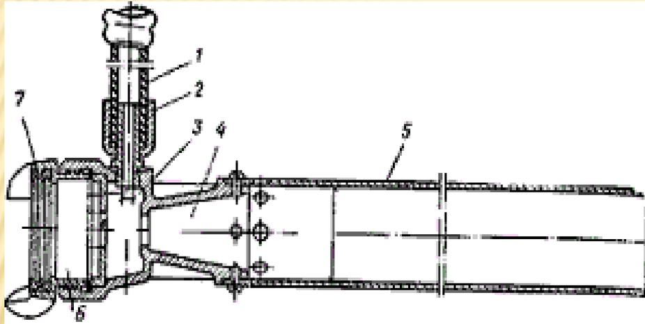
**Воздушно-пенные стволы с эжектирующим устройством** имеют дополнительный ниппель, который ввернут в корпус.
