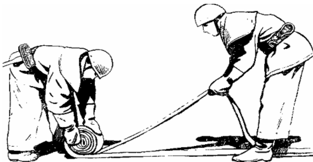
Рис. 8. Скатывание рукава в двойную скатку обучение подъему рукавных линий на высоты; тренировка в работе с пожарными стволами
