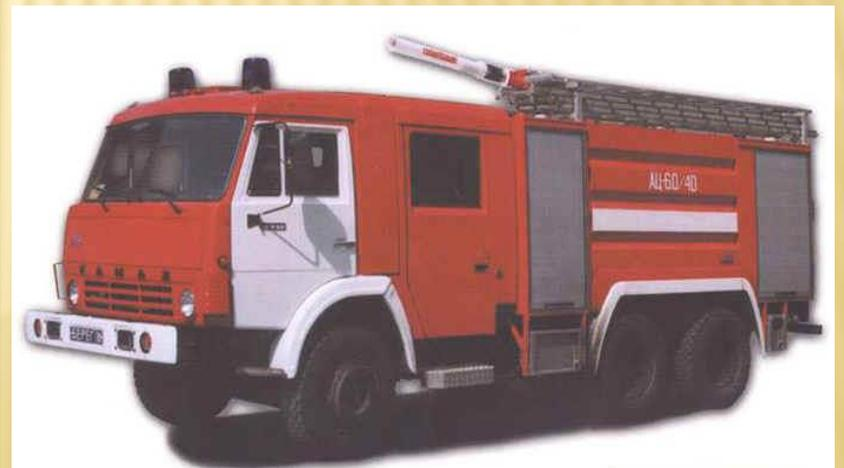
предназначен для доставки к месту пожара боевого расчёта, напорных рукавов и средств пожаротушения, прокладки напорных магистральных рукавных линий, обеспечения подачи воды или воздушно-механической пены в очаг пожара.
