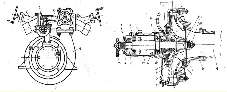
В шарикоподшипниках 6, запрессованных в корпусе насоса, расположен стальной (40X) вал 22.
