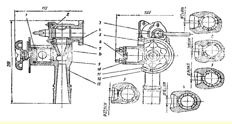
Дозировка пенообразователя осуществляется дозатором 9, который имеет пять рабочих положений.
