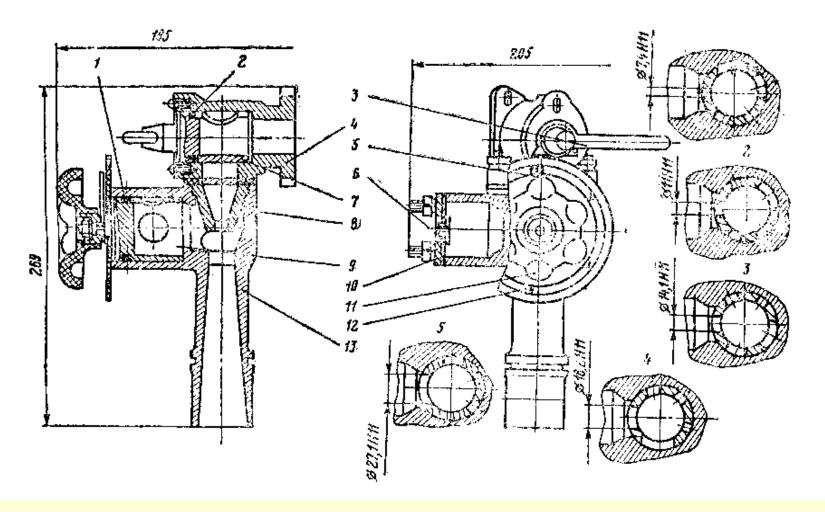
**Пеносмеситель ПС-5** служит для дозировки и подачи пенообразователя в насос.
