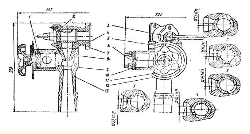
Пеносмеситель имеет обратный клапан 6, предотвращающий проникновение воды в емкость для пенообразователя во время работы насоса с подпором.
