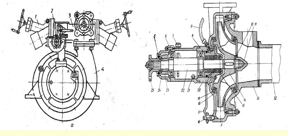
На шлицевой части вала насоса 22 посажена распорная втулка с червяком привода тахометра 23 и муфта фланца 25, закрепленная при помощи шайбы, гайки и шплинта.
