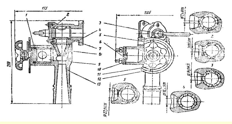
Для включения пеносмесителя следует повернуть кран ручкой 3 против часовой стрелки до упора.
