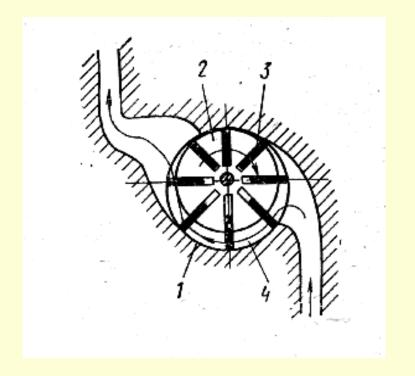
У шиберного насоса при вращении ротора 2, эксцентрично расположенного в корпусе насоса 1, в первый период увеличивается рабочий объем 4, заключенный между двумя шиберами 3, внешней поверхностью ротора 2, внутренней поверхностью корпуса 1 и двумя боковыми крышками - происходит всасывание.
