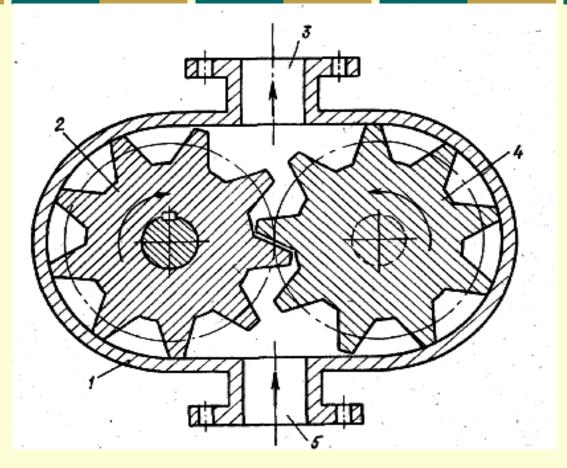
У шестеренного насоса ведущая 2 и ведомая 4 шестерни размещены с малыми зазорами в корпусе 1.
