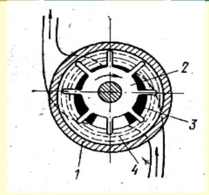
**У водокольцевого насоса** в цилиндрическом корпусе 1 эксцентрично размещен ротор 2 с радиальными лопатками, заклиненный на валу.
