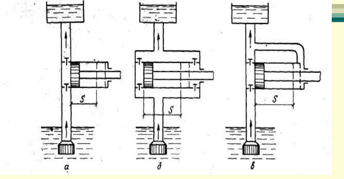
Схема поршневых насосов а - простого действия; б - двойного действия;
