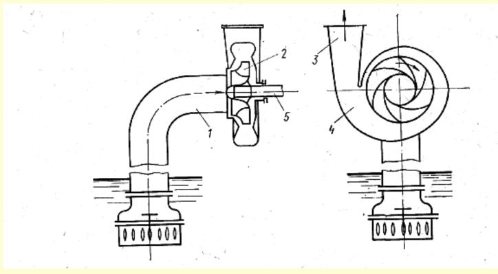
Основной частью насоса является рабочее колесо 2 с профилированными лопатками.
