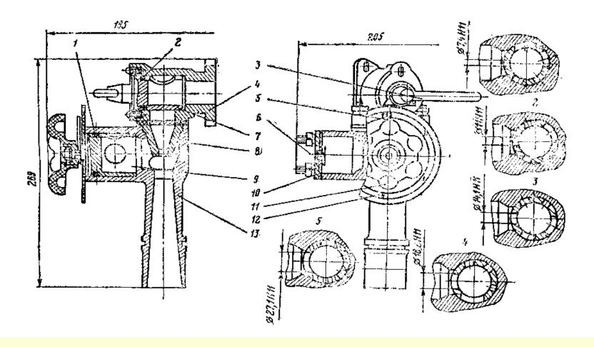
Пеносмеситель присоединен корпусом крана 4 к коллектору, а корпусом 13 - к фланцу крышки насоса.
