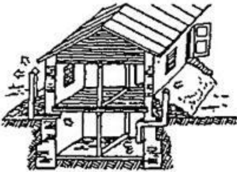
Противорадиационное укрытие в подвале дома
